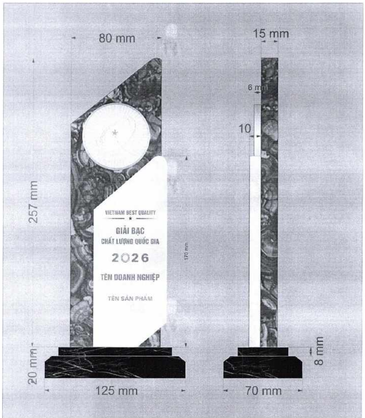
Hình 2.2. Hình dạng và kích thước mặt trước và mặt bên Cúp Giải Bạc chất lượng quốc gia
